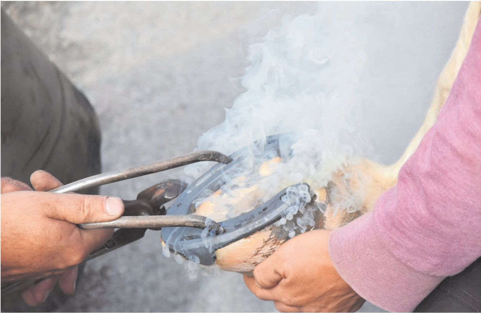
Beim Aufschmelzen des Eisens auf den Huf steigt dichter Rauch auf. Freiburger-Pferd «Hester» bleibt aber ganz gelassen, schmerzhaft ist das für die Pferde nämlich nicht.
