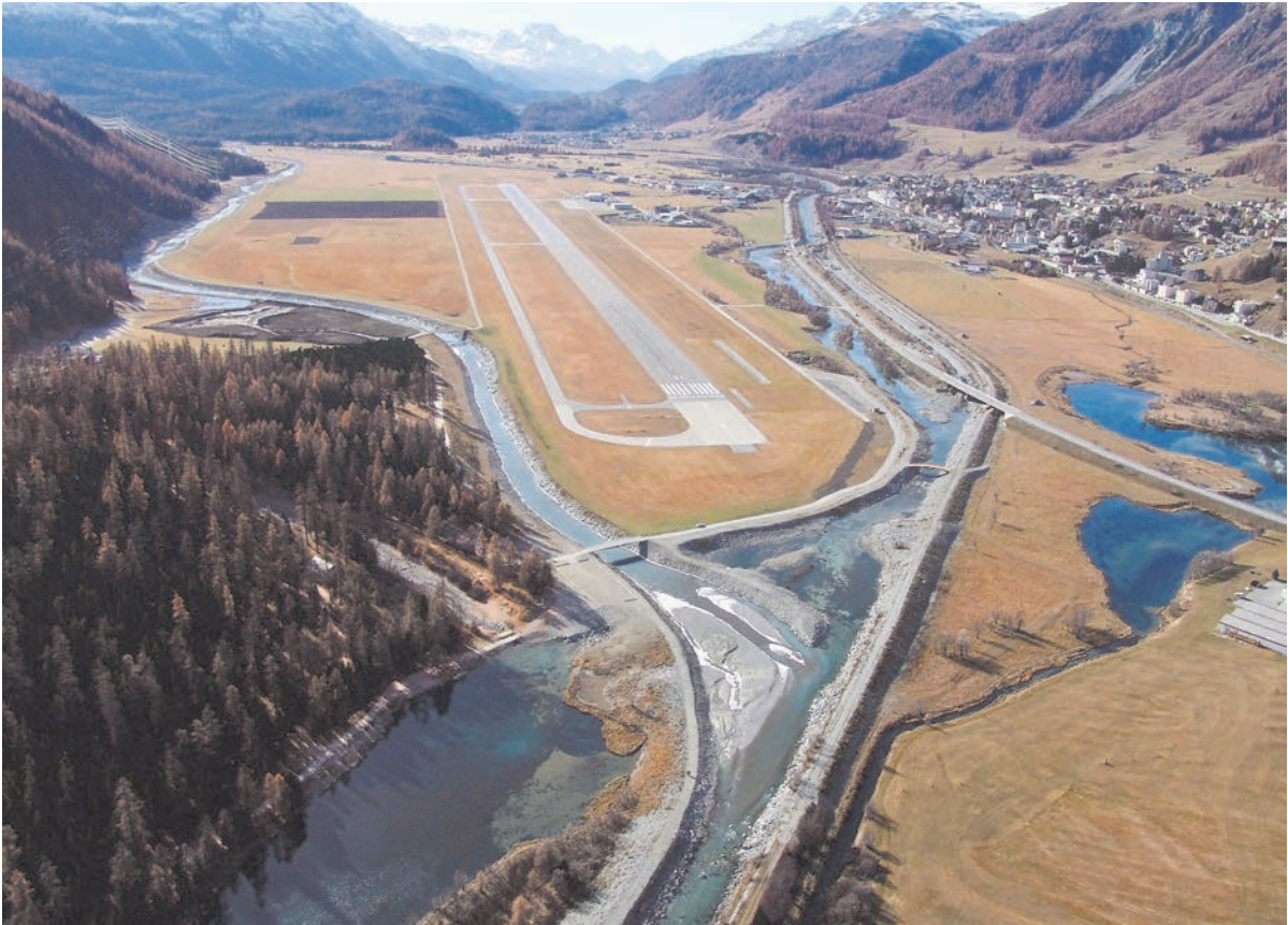
Vor der Ausführung des Hochwasserschutzprojektes floss der Flaz unterhalb der Ochsenbrücke in den Inn und anschliessend entlang des Siedlungsgebiets talabwärts (Foto oben). Das Bild unten zeigt die Landschaft nach der Verlegung des Flaz auf die andere Talseite.
