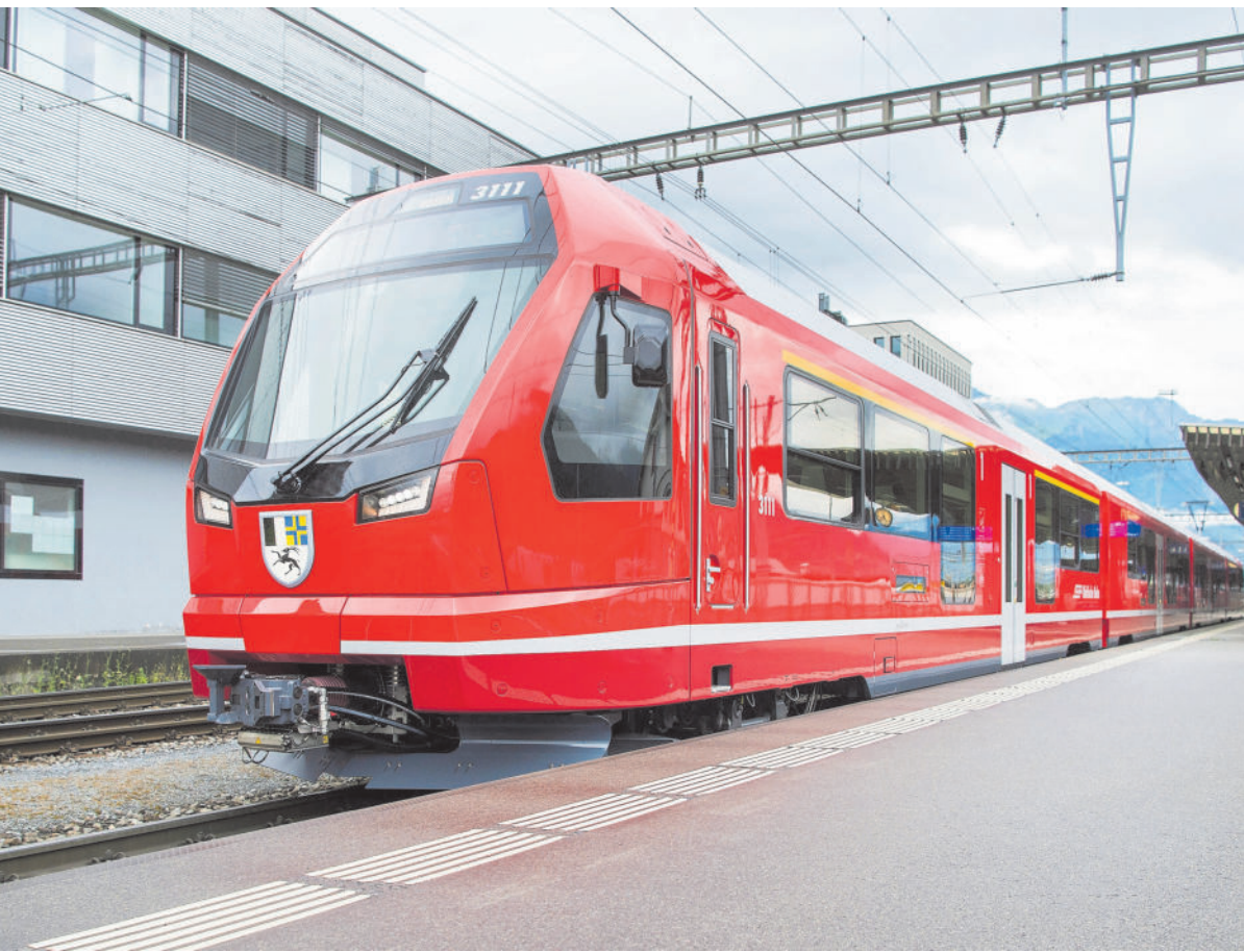
Ils trens dal tip Capricorn da la Viafier retica funcziunan cun ün accuplamaint automatic. Perque nu vo que pü da tacher landervi ün vagun ulteriur scha'l tren vess d'esser magari ferm frequento. fotografia: Samedia Press AG
