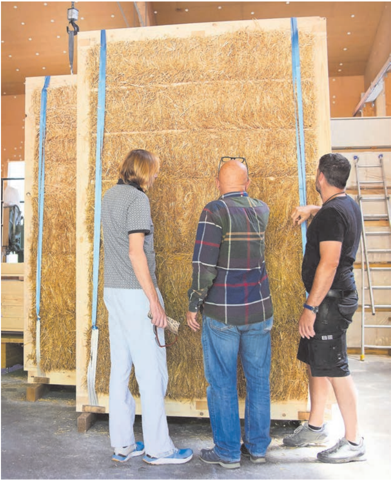
A schnestra: Inspecziun dals prüms elements da lain cun l'isolaziun da strom illa marangunaria «Be Lain» a Ramosch. A dretta: Intant amo üna fabrica scobleras otras: tanter sviamaint e staziun da la pendiculara vain fabrichà l'edifizi cun izolaziun da strom. fotografias: Michael Steiner/fmr
