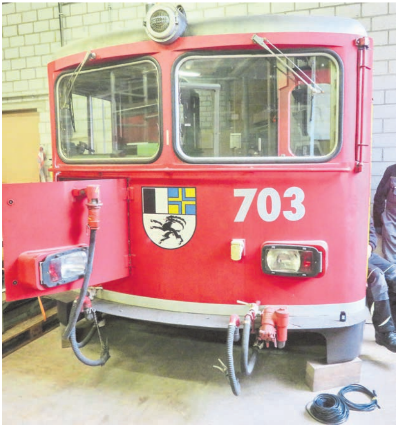
Nach dem Abbruch der Lokomotive 703 wird der Führerstand I zum Simulator (Mitte und rechts) umgebaut. Das Originalwappen der Lokomotive konnte reproduziert werden.
