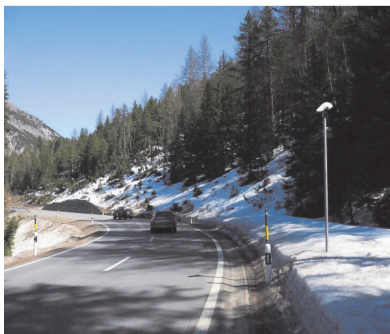
Installà daspö duos invierns sco proget da pilot sül Pass dal Fuorn: ün apparat chi masüra l'ümidità e la temperatura – tanter oter eir quella da la surfatscha da la via.
