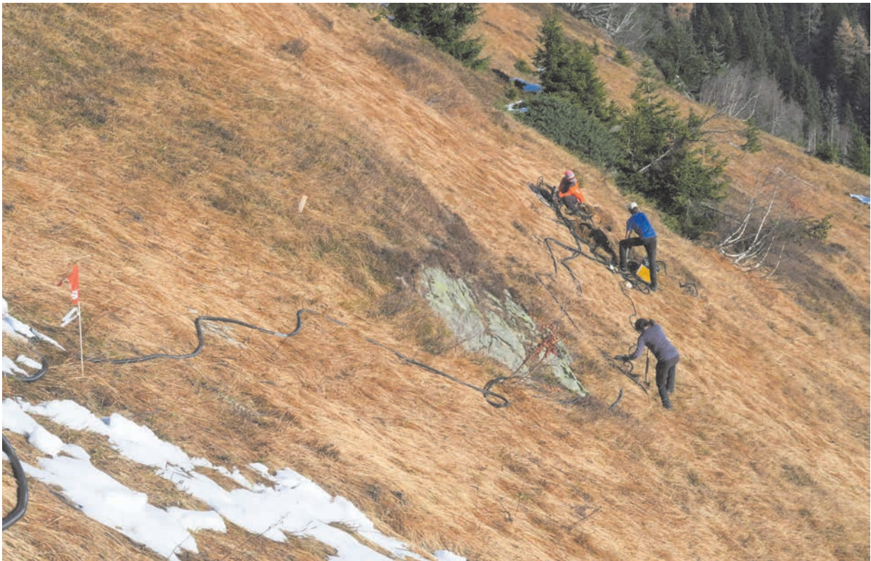
Sogenannte «Fischmäuler» gelten als Frühwarnsignal für Gletschneelawinen. Rechts: 44 Sensoren wurden am Hang installiert, an dem im Winter Gletschneelawinen abgehen. Foto: Frank Techel / SLF; Amelie Fees / SLF
