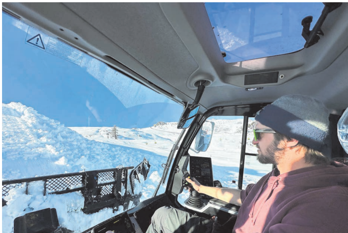
In der Kabine gibt es einige Bedienelemente: GPS, Monitor und Joystick.
