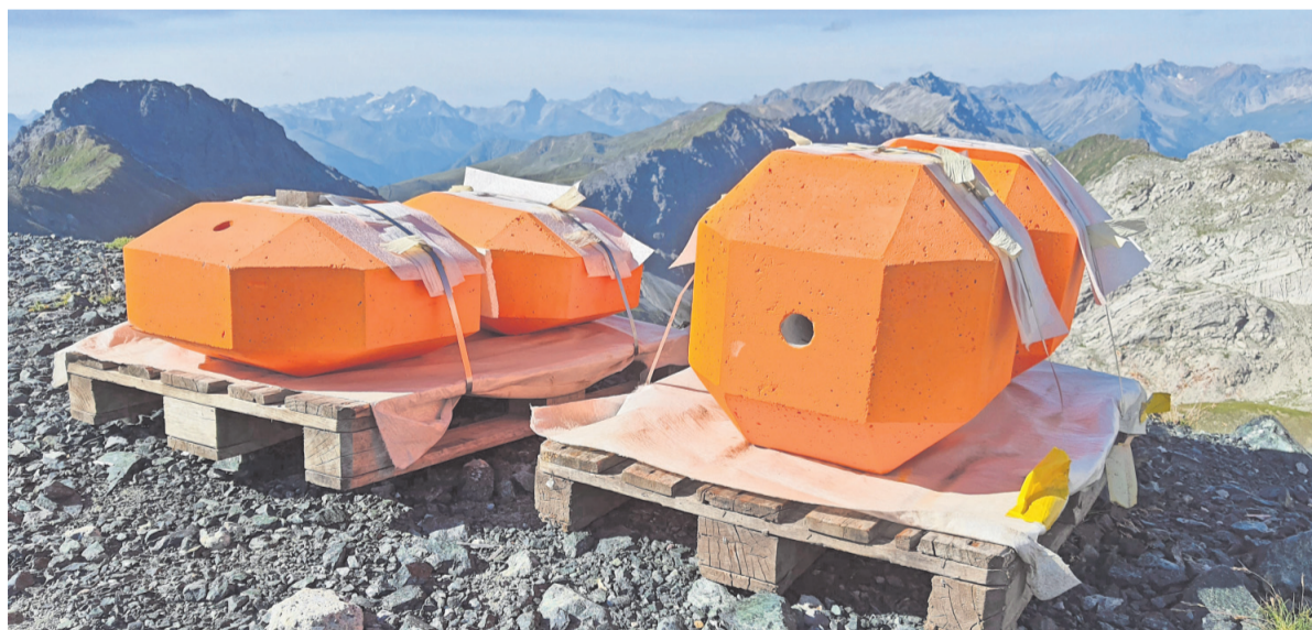
Die Forschenden stossen jeweils einen solchen, eigens angefertigten Betonblock einen schuttbedeckten Hang hinab. In dem Versuch untersuchen sie, wie Steine sich den Hang hinunter bewegen. Foto: Jochen Bettzieche/SLF
