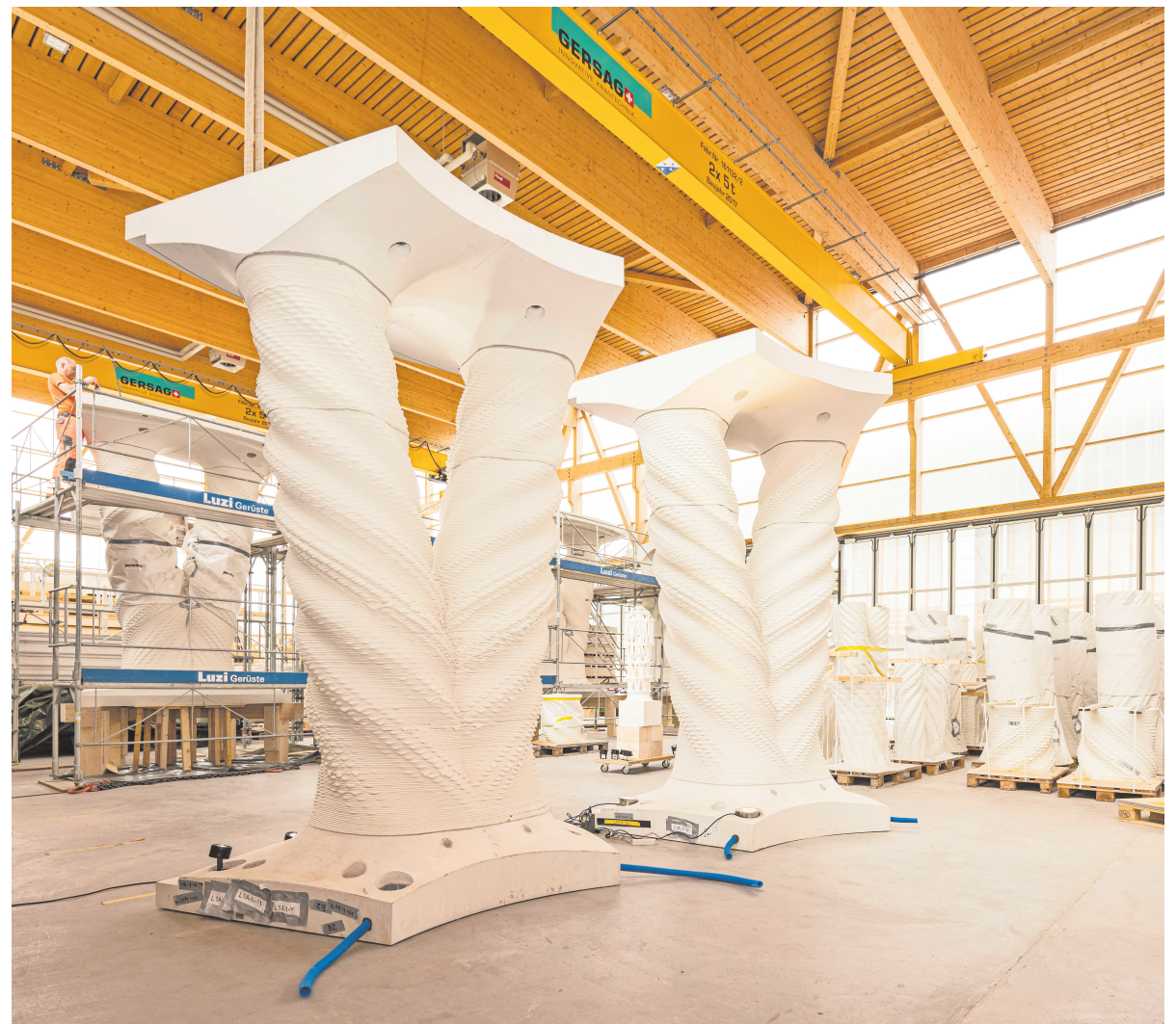
Die mittels 3D-Drucktechnologie erstellten Betonelemente zum Bau des Weissen Turms von Mulegns liegen in der Lagerhalle der Uffer AG in Savognin bereit. Foto: Mathias Kunfermann
