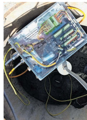
Bauen auf Permafrost am Beispiel einer schwimmend gelagerten Stütze im Gebirge (links) und Blick in ein Bohrloch mit Messinstrumenten.
