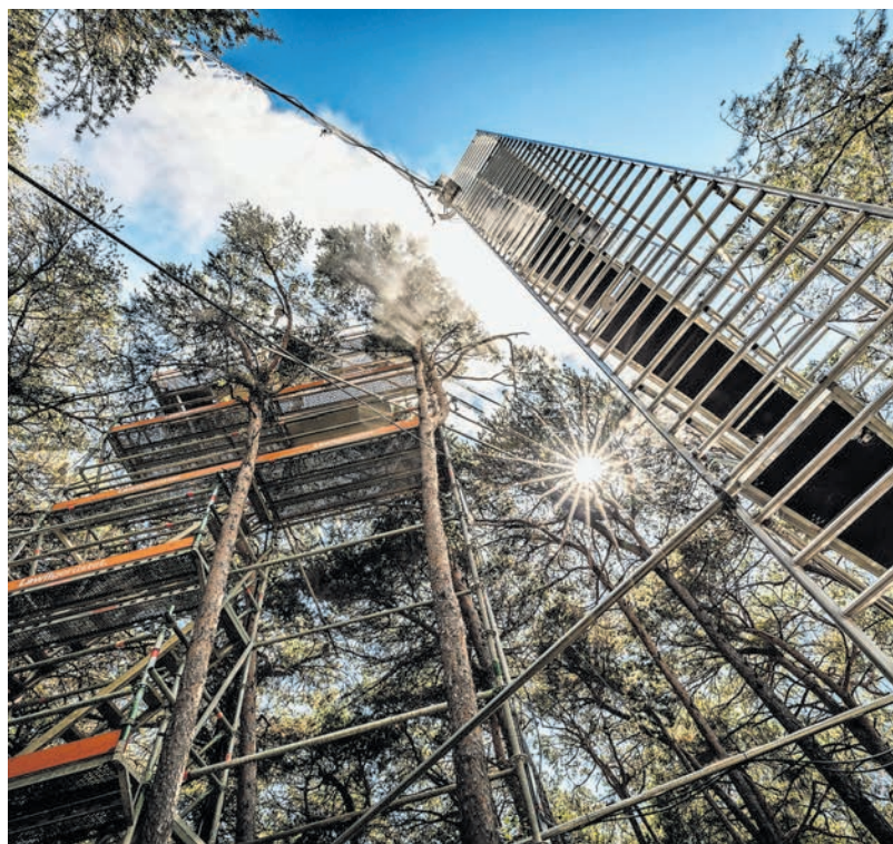
Um die Auswirkungen von atmosphärischer und Bodentrockenheit auf Bäume zu untersuchen, werden Föhren mit Wasserdampf besprüht (links). Punktdendrometer messen Schwankungen der Stammradien als Folge der aktuellen Wassersättigung des Baumes.
