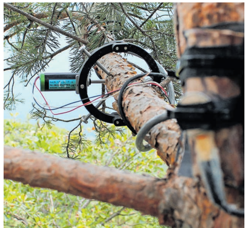
Um die Auswirkungen von atmosphärischer und Bodentrockenheit auf Bäume zu untersuchen, werden Föhren mit Wasserdampf besprüht (links). Punktdendrometer messen Schwankungen der Stammradien als Folge der aktuellen Wassersättigung des Baumes.
