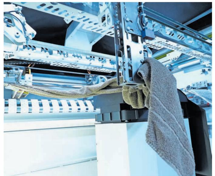
Vor Robin musste die Frotteewäsche von Hand auf eine Maschine gespannt werden. Das Innere von Robin scannt die Ecken der Wäsche und spannt sie auf ein Förderband.
