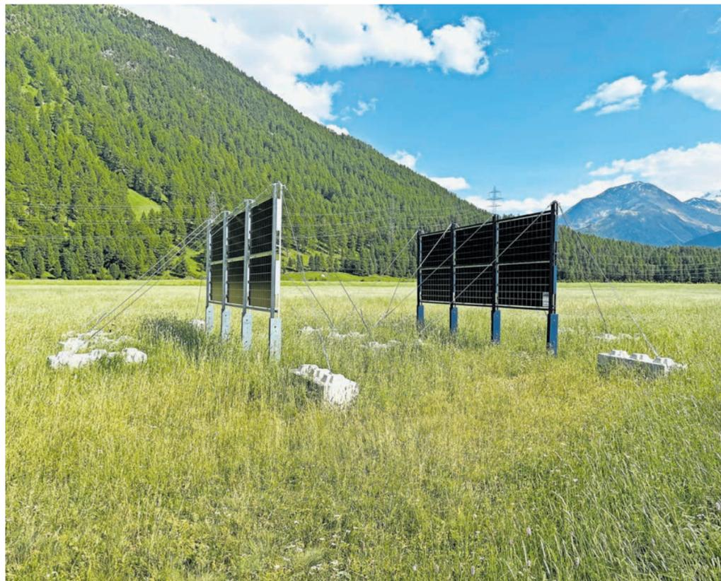
Modelle der vertikal gestellten Solarmodule. Weil beim effektiven Bau die Module auf Pfählen in den Boden kommen, braucht es keine Abspannung und Betonklötze.
