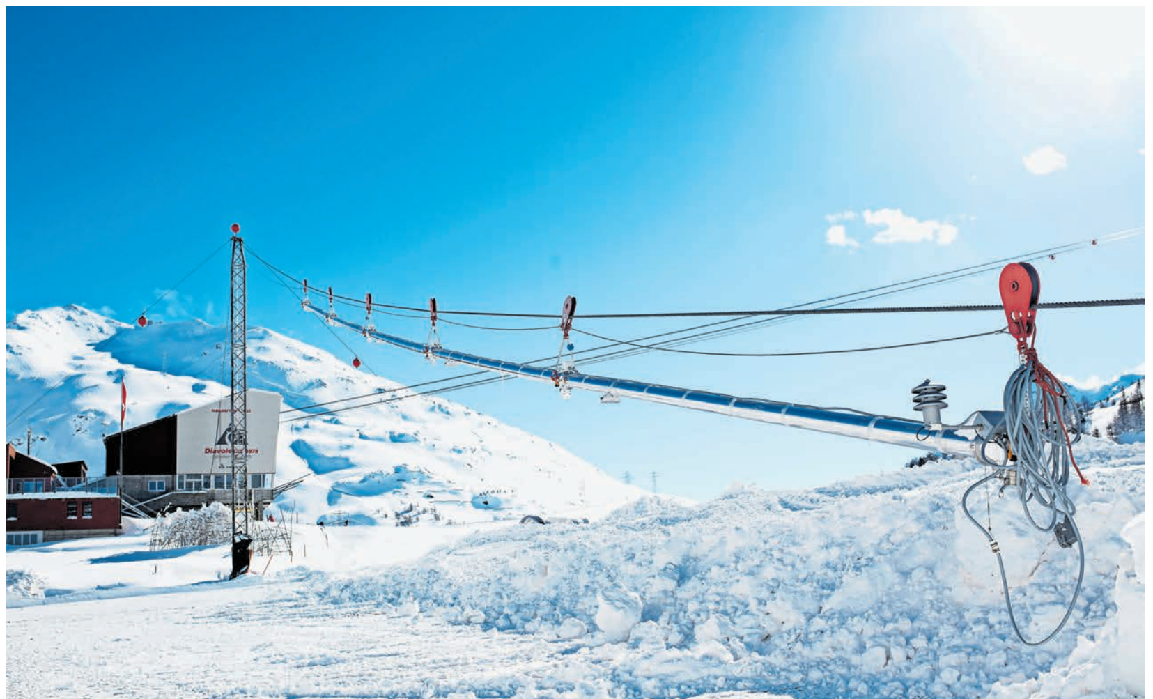
Das Beschneidungsseil als Teil einer Testanlage an der Diavolezza-Talstation. Das Projekt «MortAlive» will diese Technologie weit über den Morteratschgletscher hinaus etablieren, beispielsweise im indischen Ladakh. Foto: Mayk Wendt
