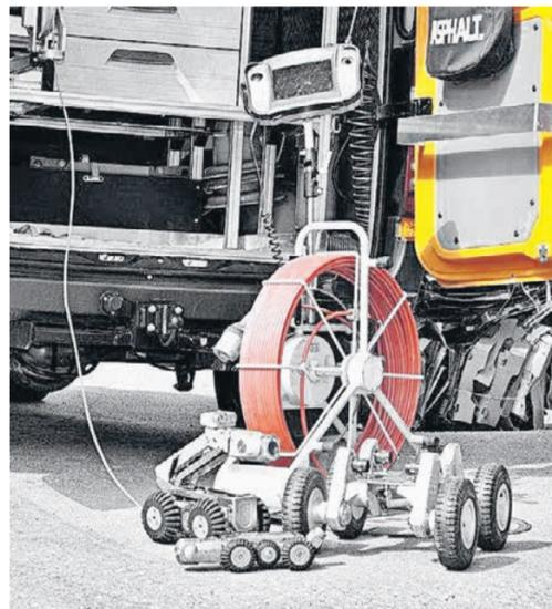
Die Firma Rudigier hat sich auch auf die bildgebende Untersuchung sowie Ortung von unterirdischen Kanälen und Rohren mit speziellen Fahrrobotern und Farblaser-Kameras spezialisiert.
