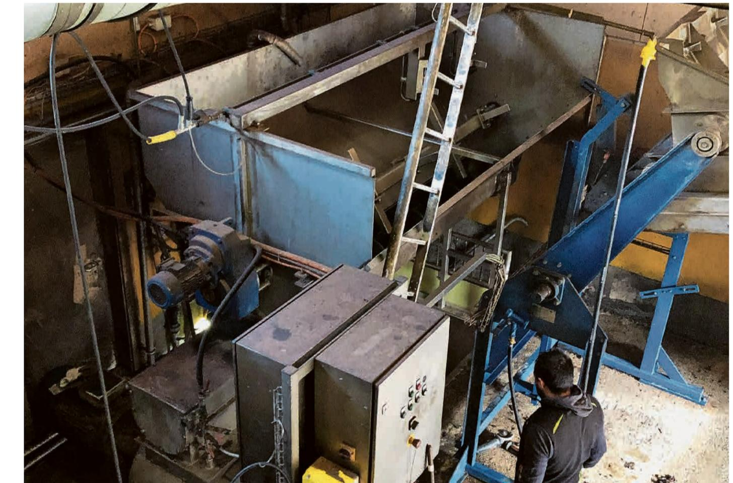
Die Kippmulde (rechts in blau) entleert die Kübel mit den Speiseresten in die Hammermühle (Bildmitte), wo sie zerkleinert werden. Darunter werden die zerkleinerten Speisereste in einer Wanne aufgefangen und anschliessend in die Kocher gepumpt.
