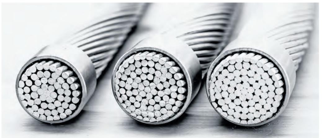
Drei verschiedene Ausführungen des Leiterseils: Links ein 32-Millimeter-Standard-Leiterseil. Mitte: dickeres und deshalb leiseres Seil für den Einsatz im Siedlungsgebiet. Rechts: ein solches mit sandgestrahlter Oberfläche.
