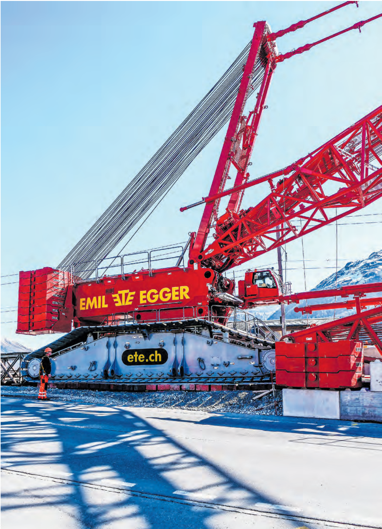
Der Liebherr Raupenkran LR 11 000 der Firma Emil Egger AG ist der leistungsstärkste Kran der Schweiz. Er steht diese Tage Eingangs Samedan und wird nach Punt Muragl (Bild unten rechts) in den nächsten Nächten in Samedan zwei weitere RhB-Stahlbrücken auswechseln. Michael Egger (Mitte) ist Egger-Geschäftsmittglied, lässt es sich aber nicht nehmen, vor Ort mitzuhelfen. Fotos: Jon Duschletta
