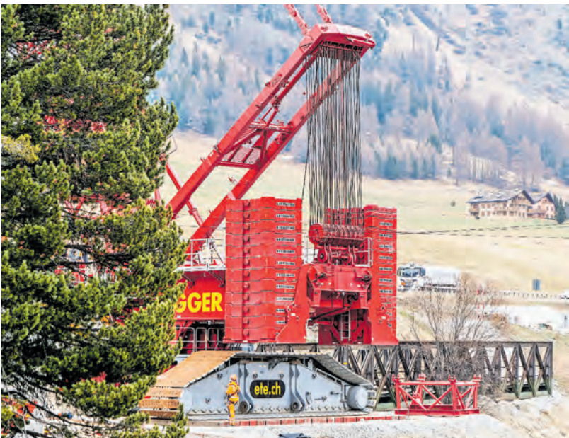
Der Liebherr Raupenkran LR 11 000 der Firma Emil Egger AG ist der leistungsstärkste Kran der Schweiz. Er steht diese Tage Eingangs Samedan und wird nach Punt Muragl (Bild unten rechts) in den nächsten Nächten in Samedan zwei weitere RhB-Stahlbrücken auswechseln. Michael Egger (Mitte) ist Egger-Geschäftsmittglied, lässt es sich aber nicht nehmen, vor Ort mitzuhelfen. Fotos: Jon Duschletta
