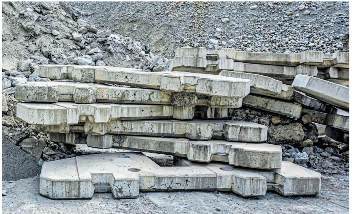
Die alten Betonblöcke werden aufbereitet und für die Herstellung von Recyclingbeton verwendet.
