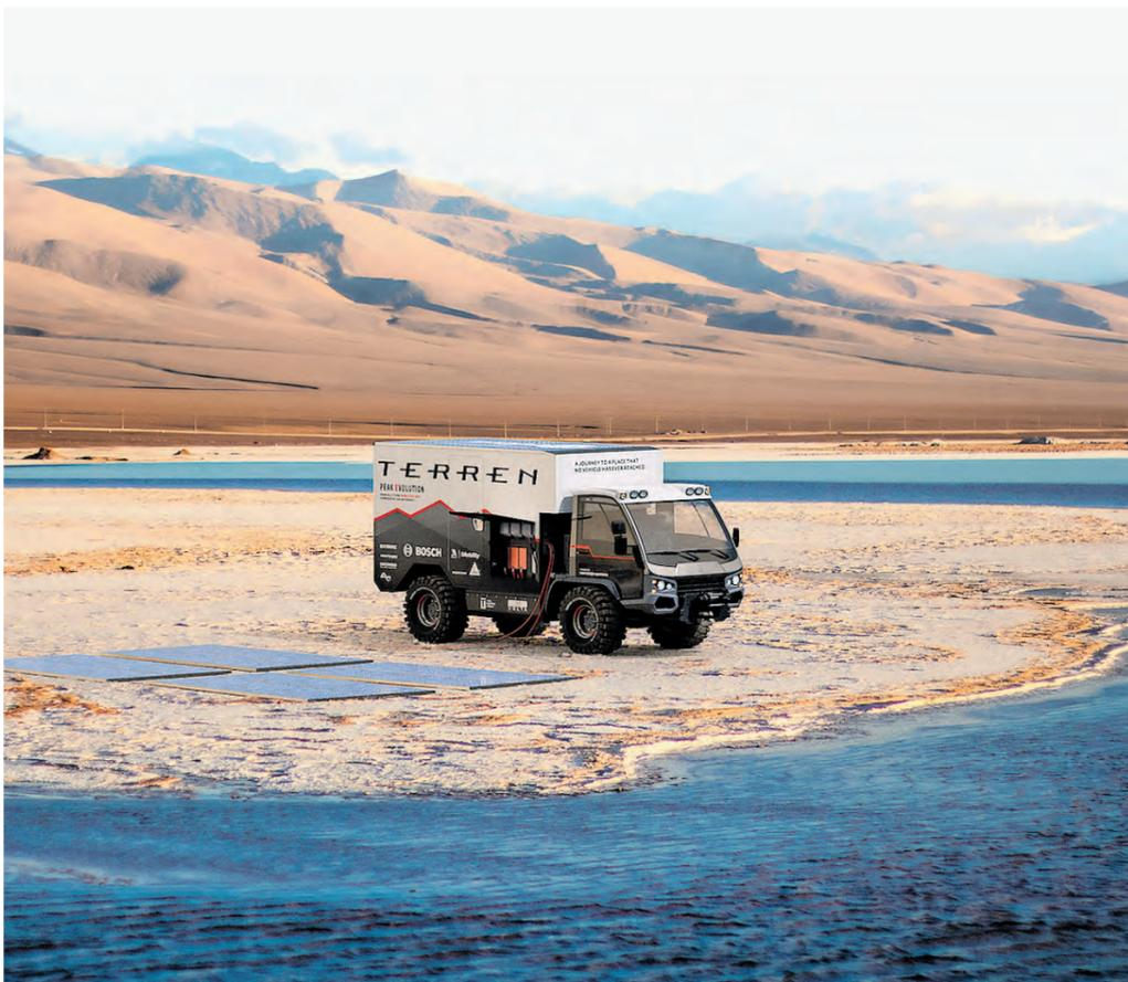
Eine Visualisierung des «Terren», mit welchem der Weltrekordversuch in Chile unternommen werden soll. Das Fahrzeug wird mit einer mobilen Solaranlage aufgeladen, welche eine Fläche von 32 Quadratmeter und eine maximale Leistung von 7,4 kW aufweist.
