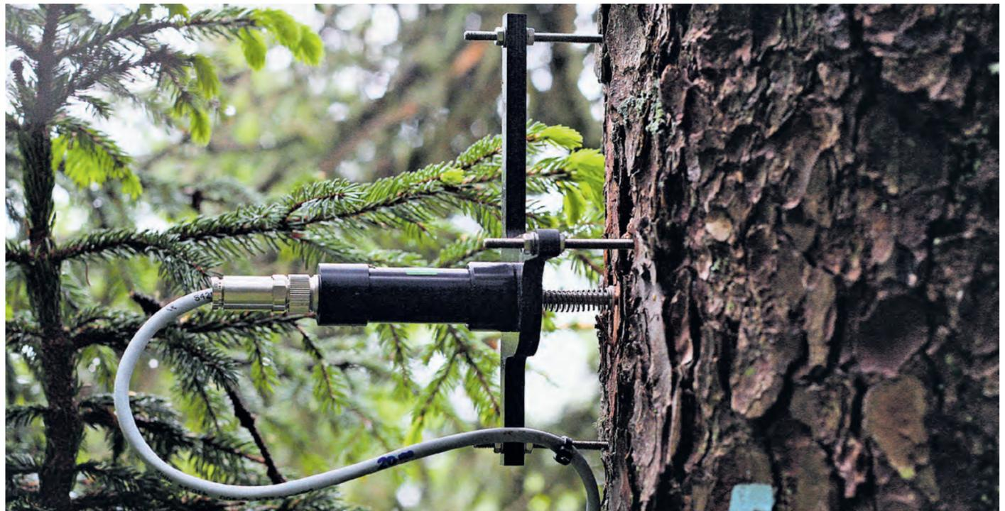
**Punktdendrometer an einem Stamm zur Messung von kontinuierlichen Stammradiusänderungen mit Mikrometereauflösung. Die Daten liefern Informationen zum Wachstum und zum Wasserhaushalt von Bäumen.**
