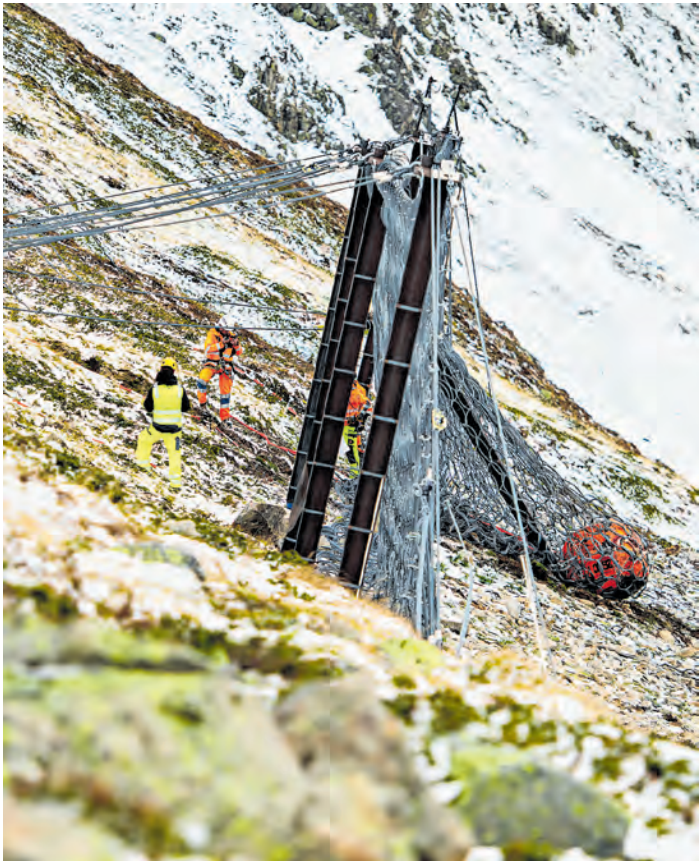
Mit einem Chip und entsprechenden Sensoren im Betonstein werden die Rotationen und die Beschleunigung gemessen und Highspeed-Kameras nehmen die Bewegungsmuster beim Einschlag in das Netz auf. Die Steinschlagtests am Flüelapass interessieren auch internationale Medien wie das Terra-X-Team vom ZDF mit dem Wissenschaftsjournalisten Dirk Steffens (Mitte).
