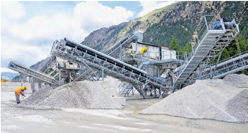
Vorbildliche Kreislaufwirtschaft bei der Betonproduktion: Im Kies- und Betonwerk Montebello in Pontresina entsteht aus Betonabbruch und Aushubmaterial Recyclingbeton: Grosse Teile werden zuerst mit einem Spezialbagger zerbrochen, dann im Brecher zu Kies und Sand zerkleinert und nach Grösse aussortiert (v.l.n.r.). Fotos: Jon Duschletta
