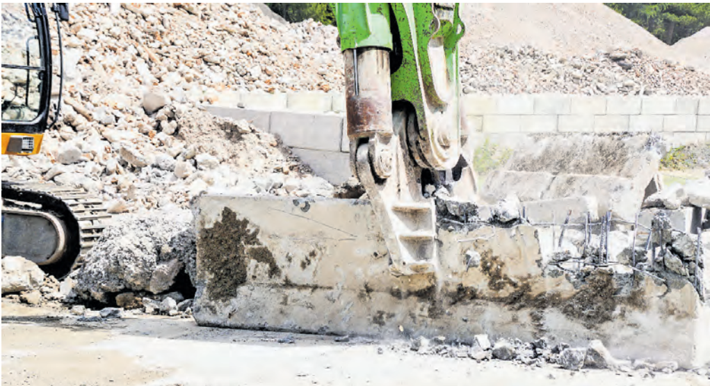
Vorbildliche Kreislaufwirtschaft bei der Betonproduktion: Im Kies- und Betonwerk Montebello in Pontresina entsteht aus Betonabbruch und Aushubmaterial Recyclingbeton: Grosse Teile werden zuerst mit einem Spezialbagger zerbrochen, dann im Brecher zu Kies und Sand zerkleinert und nach Grösse aussortiert (v.l.n.r.). Fotos: Jon Duschletta
