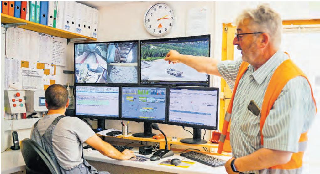
Mit Wasser und Spezialzement wird im Betonwerk Recyclingbeton hergestellt, der per Lkw auf die Baustelle gefahren und dort eingebracht wird. Bild links: Flurin Wieser im Kontrollraum der Betonproduktion.
