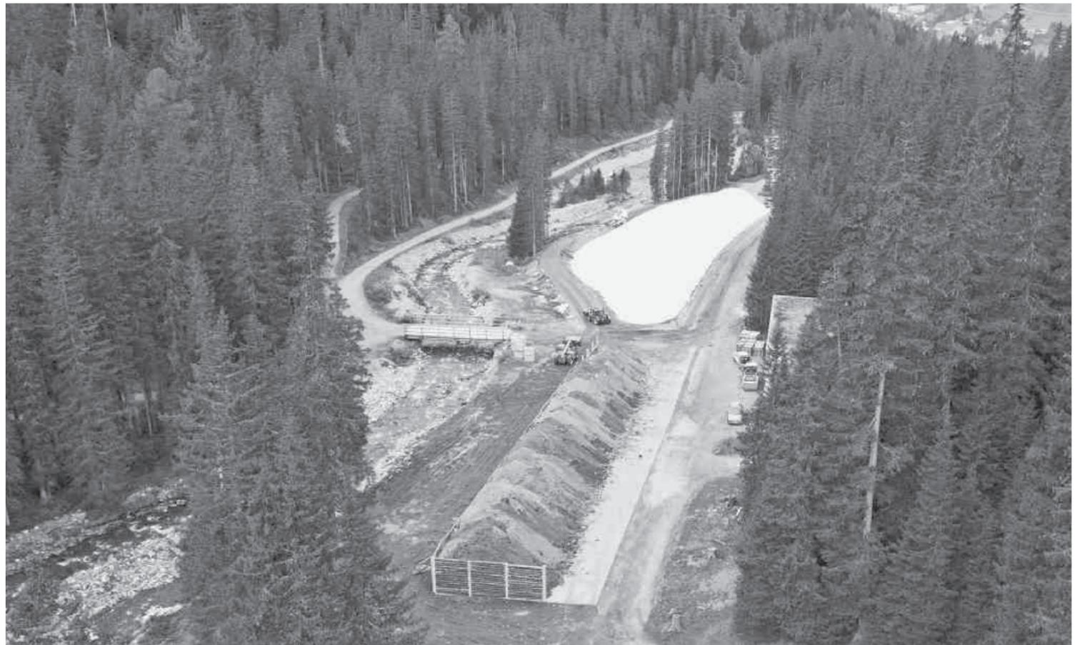
**Snowfarming ist Teil des Schneemanagements in Davos. Jeweils im Frühling wird ein Schneehaufen mit Sägespänen zugedeckt. Der Schnee wird im Herbst für die Präparierung einer Langlaufloipe verwendet.**
