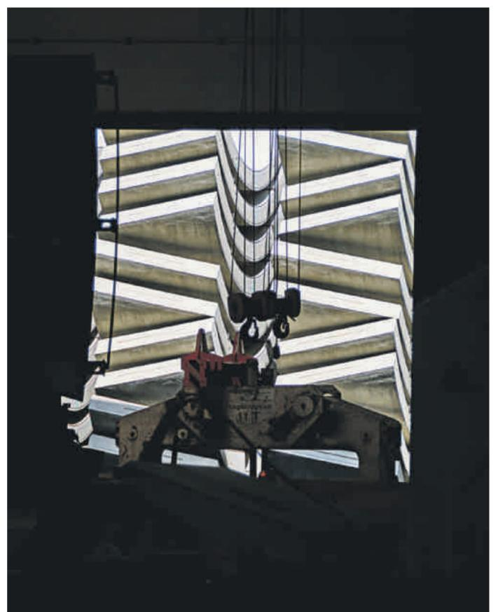
Blick aus der Tübbing-Fabrik in Marienstein auf die fertigen Betonelemente welche hier bis zum Einbau zwischengelagert werden.
