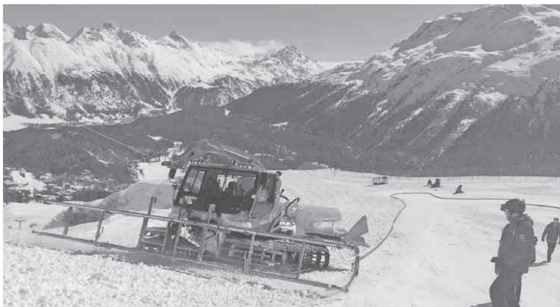
Der Wasserbalken kommt bei Rennpisten schon lange zum Einsatz. Neu beim St. Moritzer System ist, dass dieser am Pistenfahrzeug selber angebracht worden ist. Das erlaubt den gezielteren Einsatz von Wasser.
