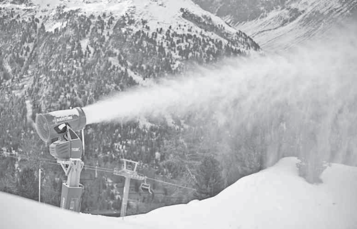
Zwei bis sieben Liter Wasser kann eine solche Propelleranlage jede Sekunde in die Luft schiessen.
