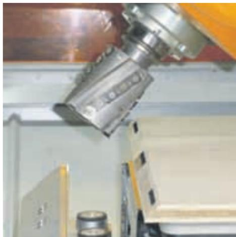
Präzise Fräsungen mit dem topmodernem 5-Achs-Bohr-Fräszentrum.
