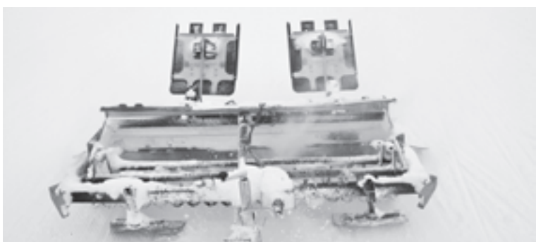
Der Spezialanhänger – von einem Langlauf-Gast geliehen – verdichtet den Schnee. Mit den zwei Platten werden die klassischen Spuren eingezogen.
