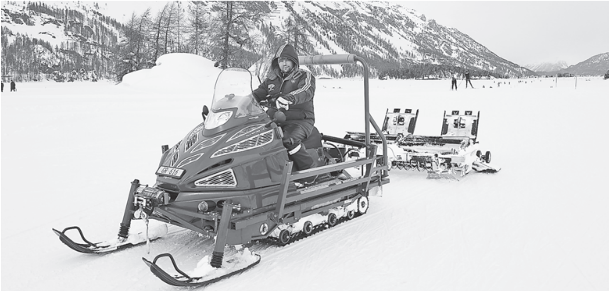
Toni Giovanoli mit seinem «Pistenbully-Ersatz». Da die oberste Schicht des diesjährig stark ausgeprägten Sandwich-Eises zu dünn ist, kann die Loipe auf den Seen lediglich mit den Skidoos befahren werden. Dieses Gefährt ist mit der seitlichen Montagevorrichtung für Schwimmer rund 900 Kilo schwer.
