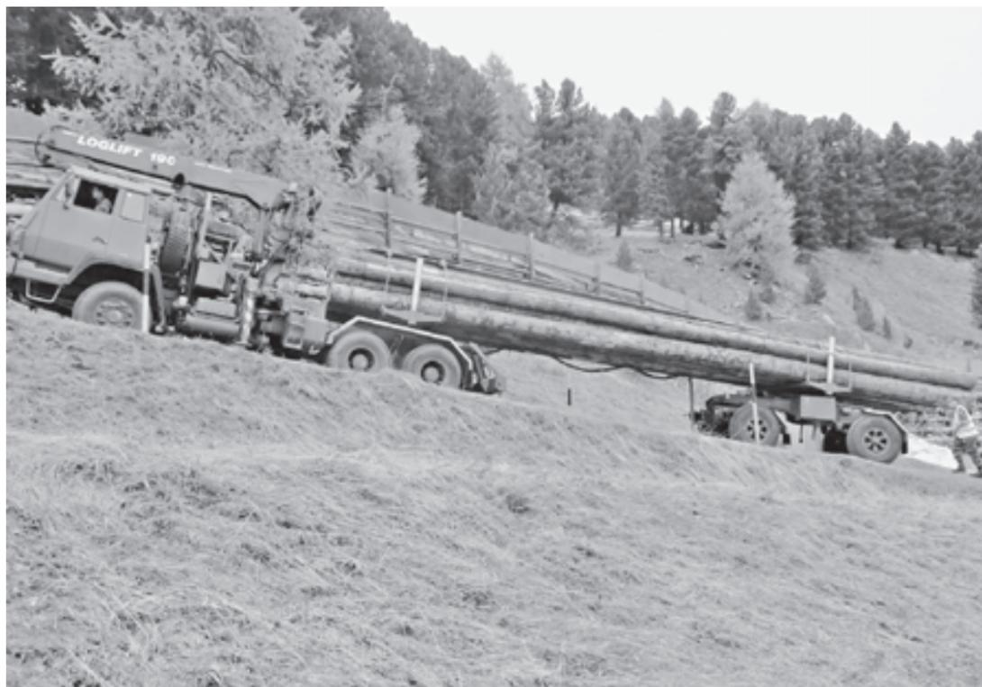
Schwertransport auf Salastrains: Auf dem Bild sieht man den Soldaten, der den hinteren Teil des Lastwagens steuert.
