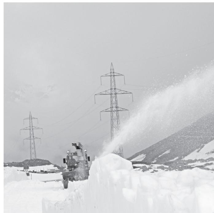
Von oben nach unten wird eine Schneeschicht nach der anderen weggeschleudert.
