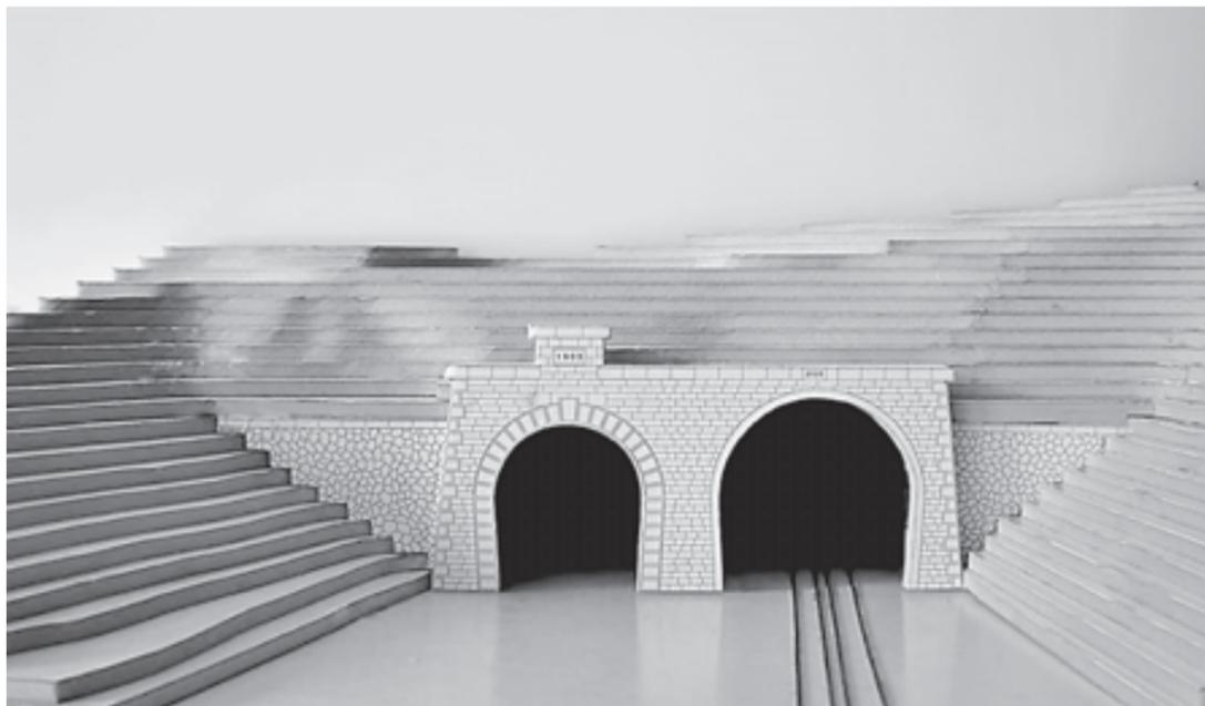
Die Möglichkeiten zur Portalgestaltung wurden in Modellen dargestellt. Das neue Portal ist rechts vom bestehenden angeordnet (Fahrtrichtung Spinas – Bever) und hat ein grösseres Profil. Modell: Rhätische Bahn
