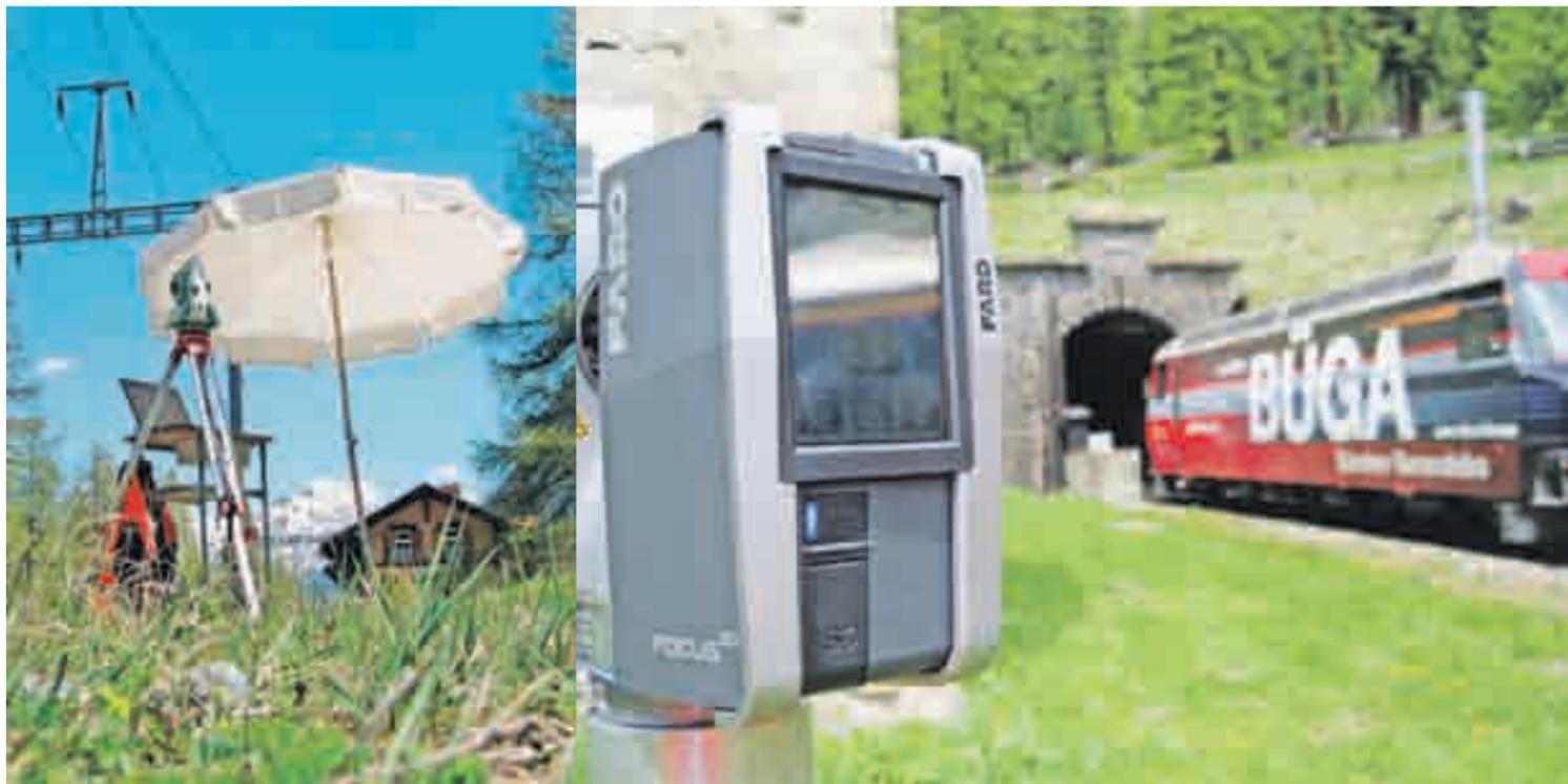
Der Neubau des Albulatunnels hat auch Folgen für die Stationsgebäude. Da sie allenfalls verschoben werden müssen, werden sie derzeit auf den Zentimeter genau vermessen.
