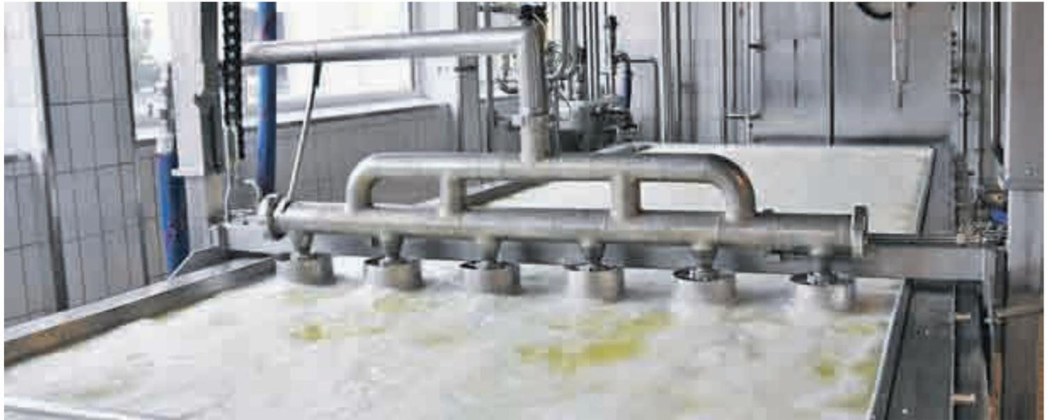
In der Abfüll- und Presswanne wird die Käsemasse in die richtige Form gepresst. So können 108 Käselaibe gleichzeitig produziert werden. Fotos: Vanessa Müller
