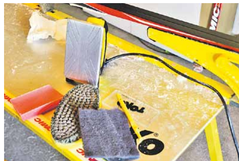
Zum Wachsen braucht es keine High-Tech-Ausrüstung: Bügeleisen, Bürste, Universalwachs, Abziehklinge – und es kann losgehen.
