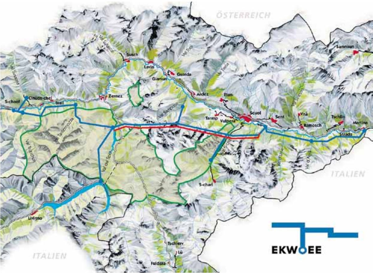
Cun ün seguond tunnel parallel da l’Ova Spin fin Pradella voul evitar Peter Molinari, directer OEE, la perdita tras fricziun ed augmantar in möd ecologic la producziun d’energia per 32 gigawatts l’ura.
