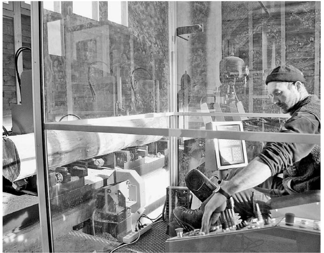
Säger Andri Thom steuert im modernen, computergestützten Leitstand die Blockbandsäge.
